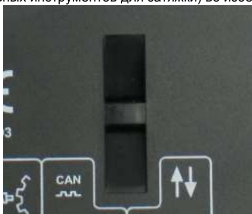
Точка крепления кабеля
