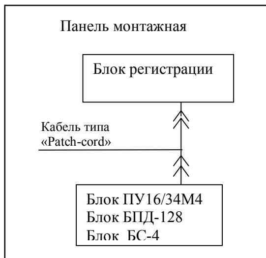
Рисунок 12 Схема монтажа регистратора при местном подключении блоков ПУ16/32М4, блока БПД-128М4 и блока БС-4
