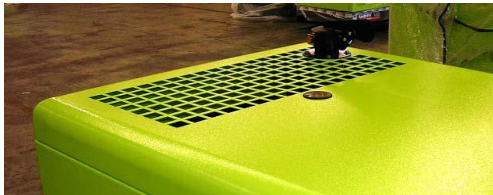
GSW: вертикальный выброс из камеры вверх
