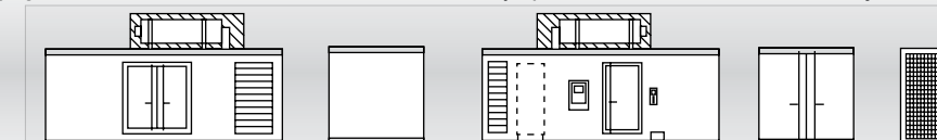
60/65 dB(A) 20'-20'HC Container . Контейнер (6,1 × 6,1 м, большой кубатуры, с шумоизоляцией 60/65 дБА)
